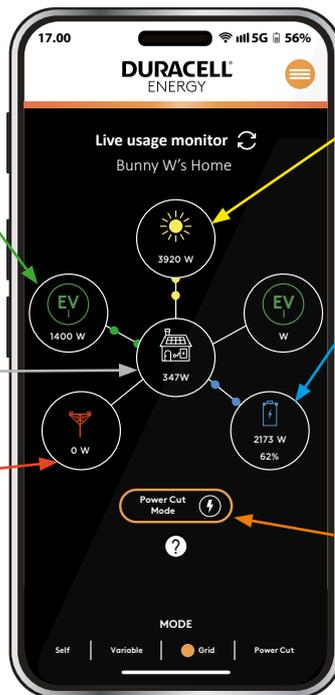
**Bulle PV :** Cette bulle présente les relevés du système photovoltaïque (PV). Les valeurs doivent toujours être positives. En cas de relevés négatifs, contactez le support client.
