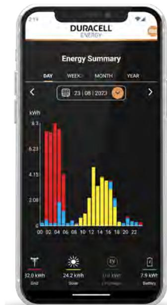
Le résumé énergétique fournit un rapport historique détaillé de la répartition totale de l'énergie de votre système. Les différentes sources d'énergie sont représentées par des couleurs distinctes :
