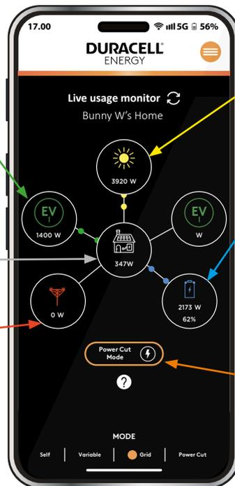
**Bulle PV :** Cette bulle présente les relevés du système photovoltaïque (PV). Les valeurs doivent toujours être positives. En cas de relevés négatifs, contactez le support client.
